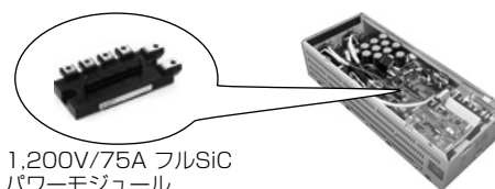
図6. SiCパワーモジュール搭載パワーコンディショナ
