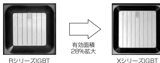
図2. IGBTチップの有効面積拡大
