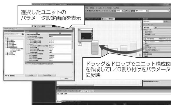
図4. ユニット構成図によるパラメータ設定
