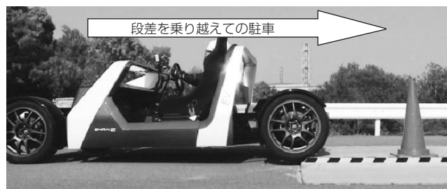
(a) 自動駐車制御の実験
