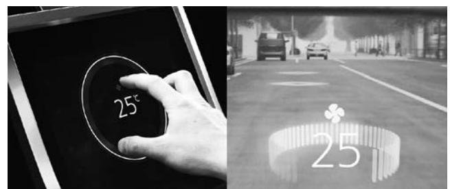
図4. マルチタッチとHUDを利用した視線移動低減HMI
