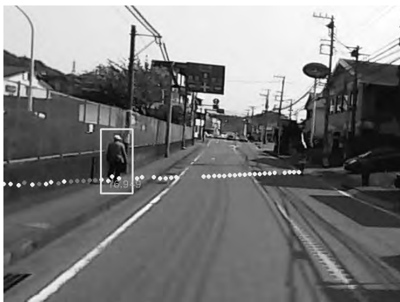
図2. 入力画像とレーザセンサ測定例
