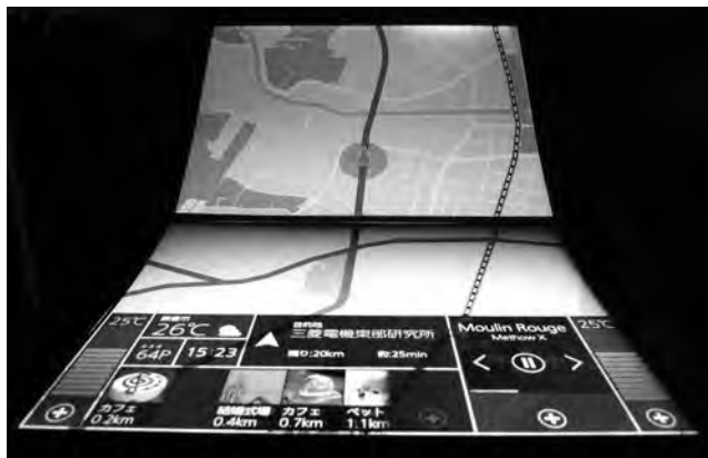
図9. 光拡散機能を付与した試作機の点灯状態
