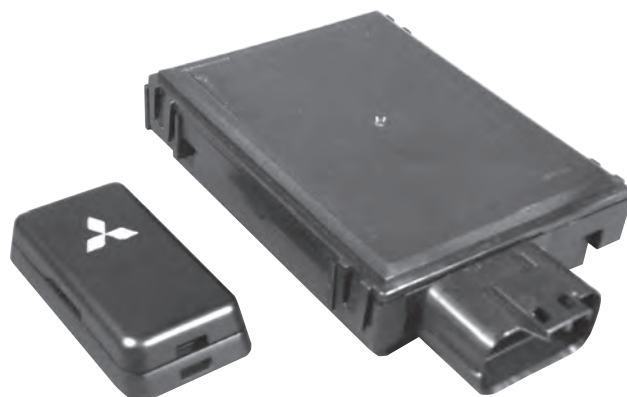
スマートキー 制御ユニット 二輪車向け第2世代スマートキーレス
