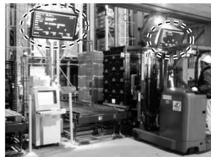
図8. 自動倉庫出庫口に設置した大型液晶モニター
