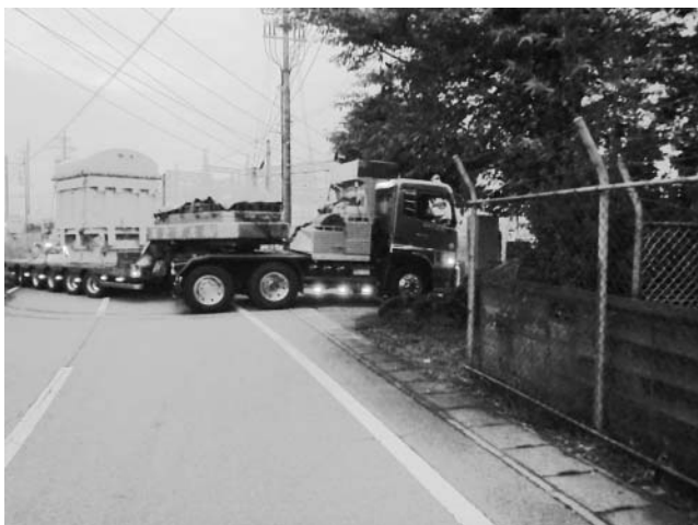
図9. 低床トレーラーでの変圧器輸送
