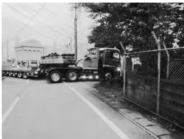
図9. 低床トレーラーでの変圧器輸送
