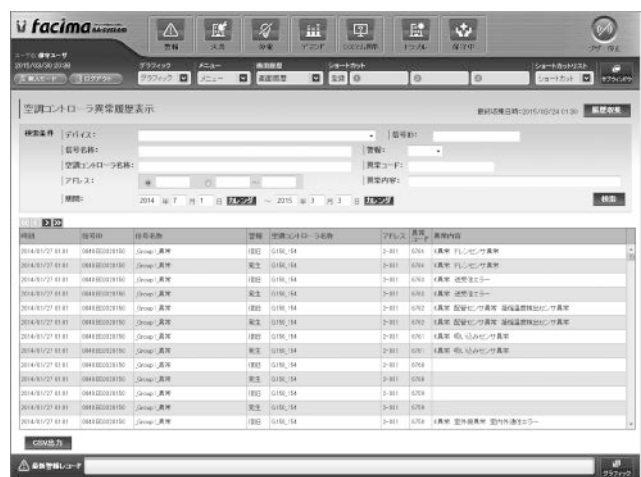
図 8. 空調コントローラの異常履歴画面
