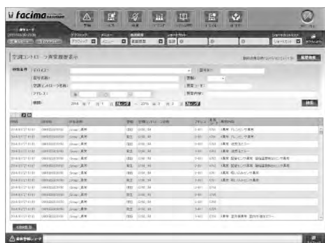
図 8. 空調コントローラの異常履歴画面
