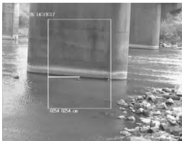
図5. 河川の水位を画像から検知する事例
