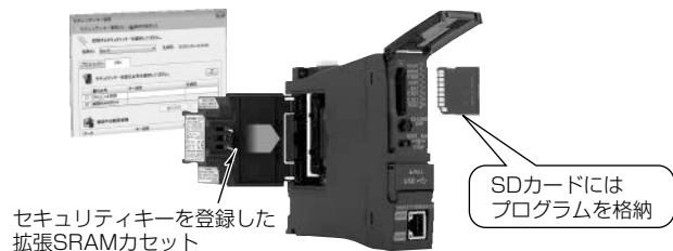
図8. 拡張SRAMカセットによるセキュリティキー認証
