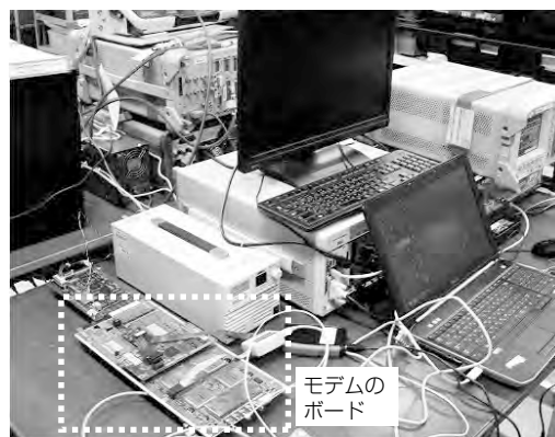
図7. モデムの評価測定の様子
