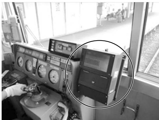
図1. 在線検知車載機
