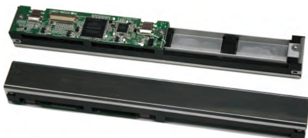
図1. 高分解能ライン磁気センサMICMO
