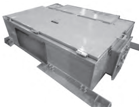
LRV向けVVVFインバータによる推進制御装置
