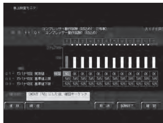
車上検査機能画面例(コンプレッサ動作試験)
