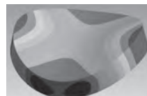
収差補正鏡のレーザー反射面の変形模式図
