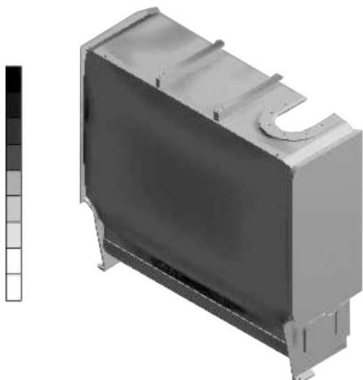
図7. 開発タンクの応力分布(1/2モデル)
