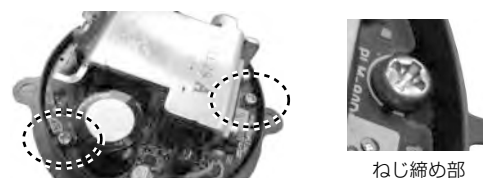
図7. ねじによる固定(80mmサイズDCモータ)
