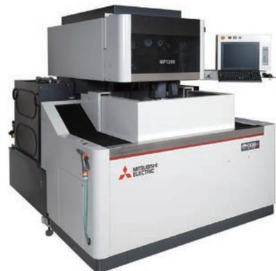
図5. 当社開発の最新ワイヤ放電加工機
