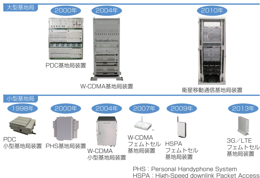
図1. 電気通信事業者用無線基地局の変遷
