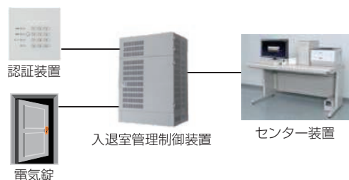
図5. 入退室管理システムの基本構成
