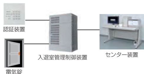
図5. 入退室管理システムの基本構成
