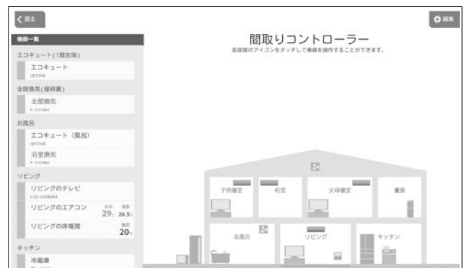
図4. 間取りコントローラの表示例
