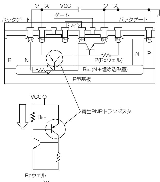
図3. CMOS断面
