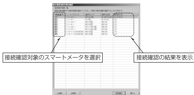
図7. スマートメータの接続確認画面
