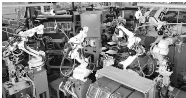
図7. 鋼板フレームの製造ライン
