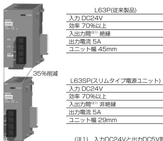
図2. 従来製品とスリムタイプ電源ユニットの仕様比較
