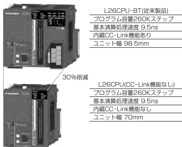
図3. 従来製品とL26CPUの仕様比較
