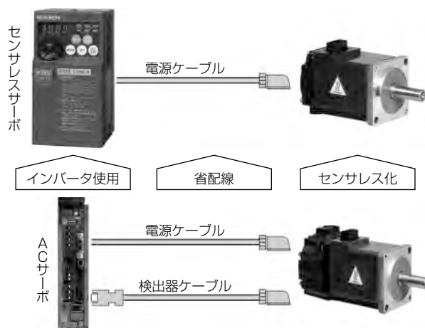
図2. センサレスサーボによる駆動システムのコスト低減
