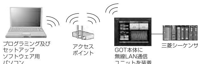
図7. 無線LAN接続構成
