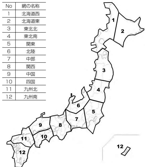
図4. センチメータ級補強情報の網構成例
