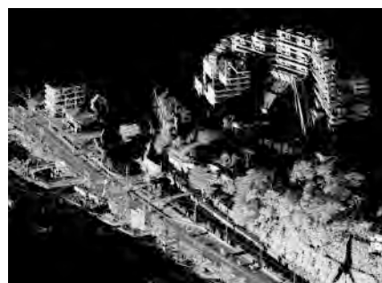
図6. 長距離レーザ搭載MMSの計測
