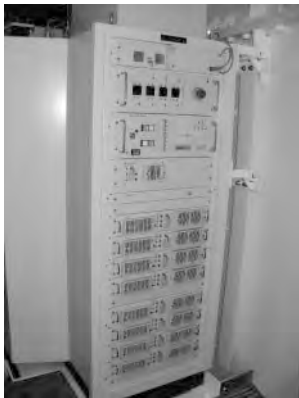
図 6. S帯 1 kW電力増幅装置の外観(画像提供：JAXA)
