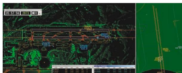
空港面 (中央)、空域 (右)、飛行計画情報 (下) を表示。空港面表示の滑走路右側の数字は到達予測時間、滑走路を囲う枠は滑走路使用中、赤線はRWSL点灯中であることを示す。
