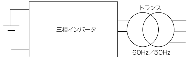
図1. 従来型補助電源装置
