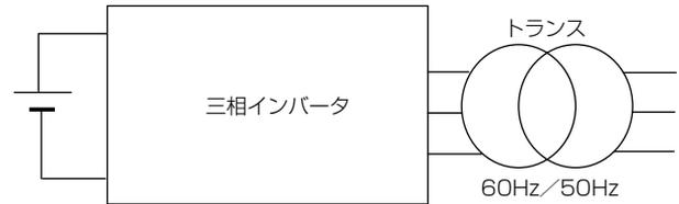
図1. 従来型補助電源装置
