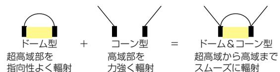
図3. トゥイーターのドーム&amp;コーン振動板構造
