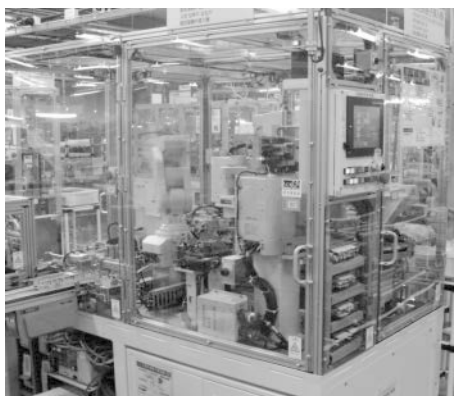
図5. 電磁接触器の自動組立装置
