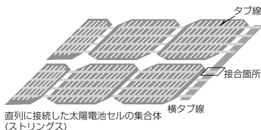
図7. タブ線と横タブ線間のはんだ接合箇所
