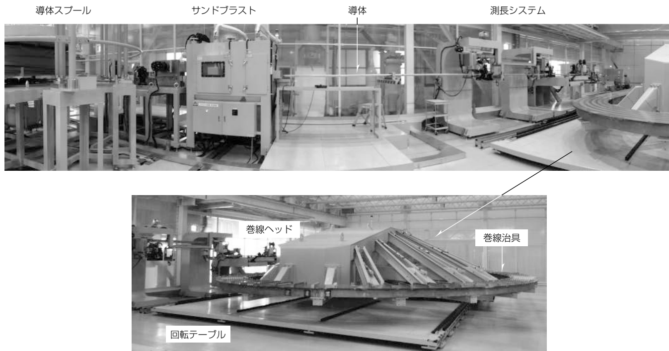
図 3. ITER TFコイルの巻線装置(提供：日本原子力研究開発機構)
