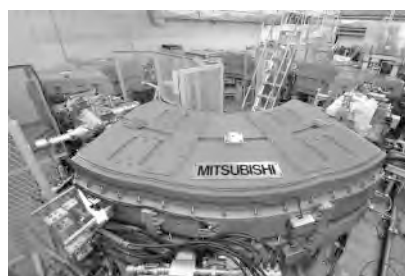
図 5. 新型シンクロトン加速器
