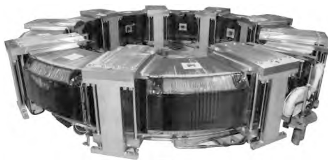
図 6. JT-60SAのEF4コイル(提供：日本原子力研究開発機構)
