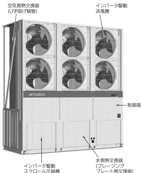
図1. EAHV形(30馬力基本モジュール)の外観 (正面：空気熱交換器吹き出し部)
