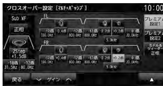
図12. クロスオーバー・ネットワークの調整画面
