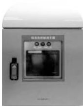
図5. 可搬型モニタリングポスト
