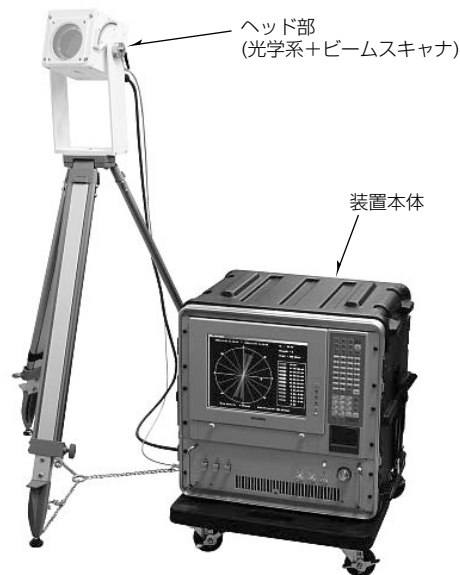
図3. 小型光ファイバドップラーライダー
