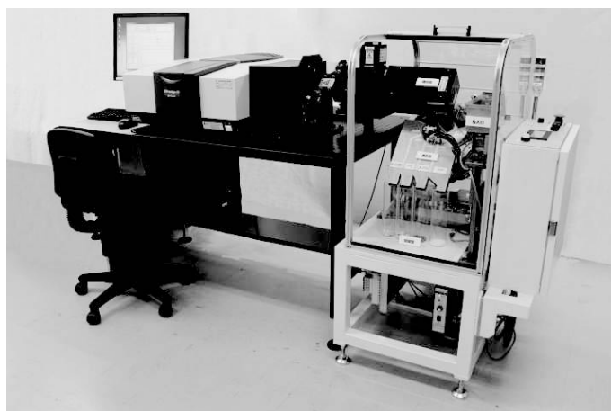
図4. 中赤外分光応用樹脂種識別装置
