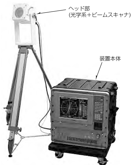
図3. 小型光ファイバドップラーライダー
