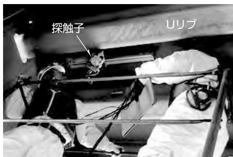
実橋での探傷の様子
