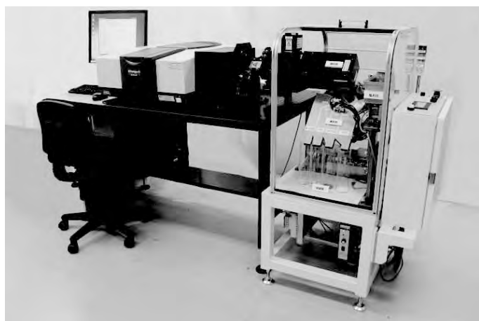
図 4. 中赤外分光応用樹脂種識別装置
