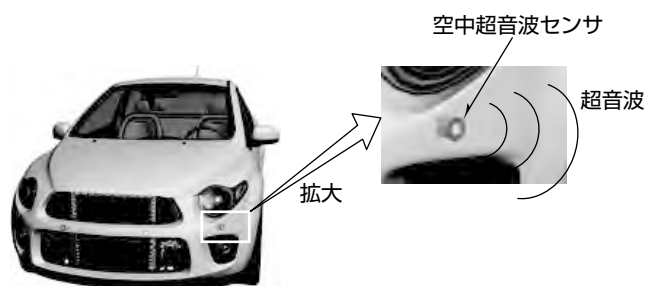
空中超音波センサの設置例
