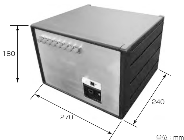
図7. 光計測器試作品
