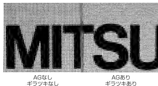
図3. AGと画素ピッチ干渉によるギラツキ発生サンプル
