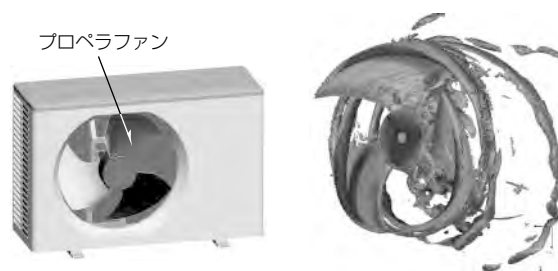
図6. エアコン室外機(左)とファン周囲の温度 \omega 等値面(右)
