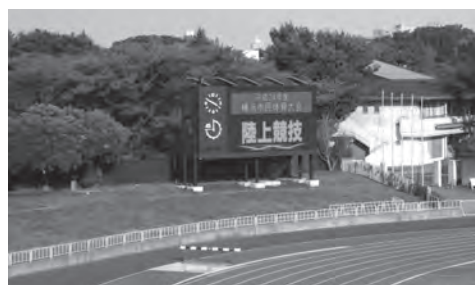
【スクリーン仕様】 ODQ12(25mmピクセルピッチ、BRRG直交配列1in1素子) : (H) 5.0×(W) 8.4(m) 42m 2 385型
