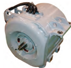
図 2. DC1,500V架線対応高効率全閉形誘導電動機
