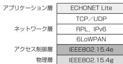
図1. ECHONET Liteの下位層のプロトコルスタック例
