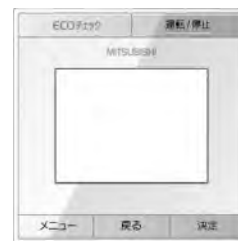
図 6. 試作したHEMSコントローラ(109×109(mm))
