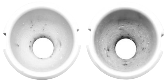
(a) 低損耗ノズル (b) 従来ノズル
