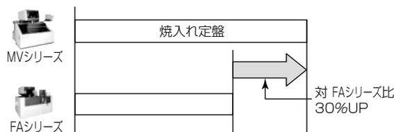
図8. MVシリーズの定盤硬度比較
